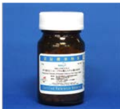
NMIJ CRM 8152-a ポリ塩化ビニル (フタル酸エステル類分析用) Polyvinyl Chloride (Phthalate Esters in PVC Resin Pellet)
